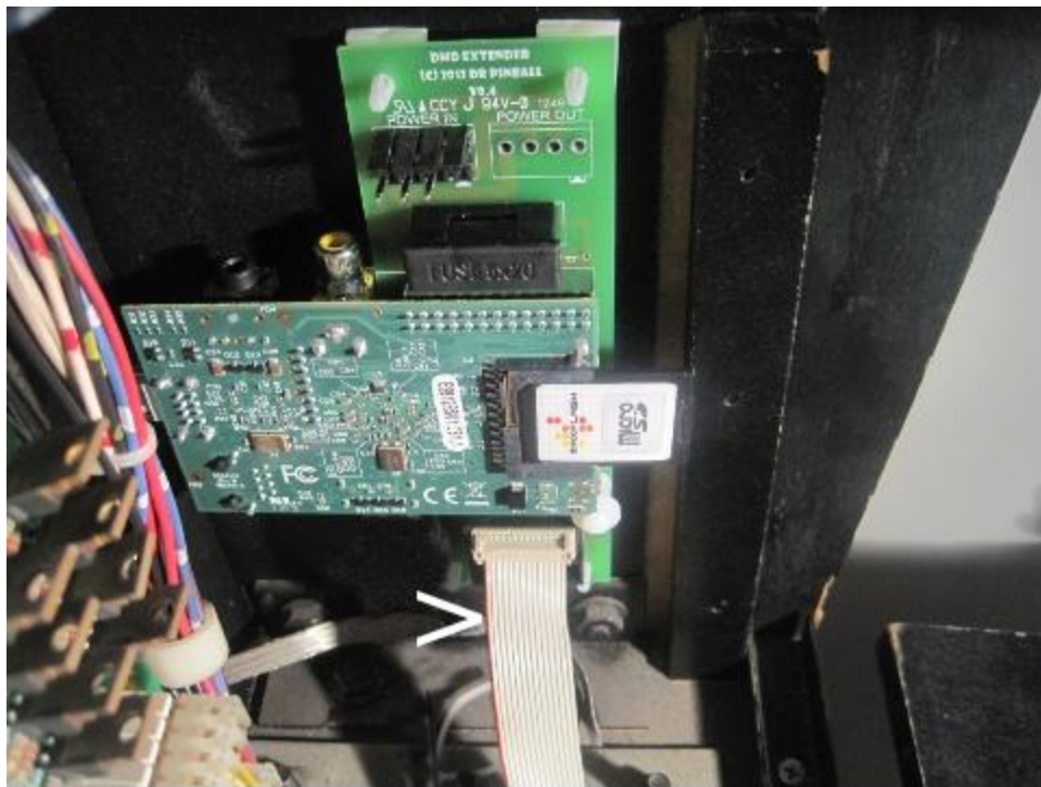
Bild 10 – Flipper DMD Bildschirm-Flachbandkabel – rote Ader auf der linken Seite
