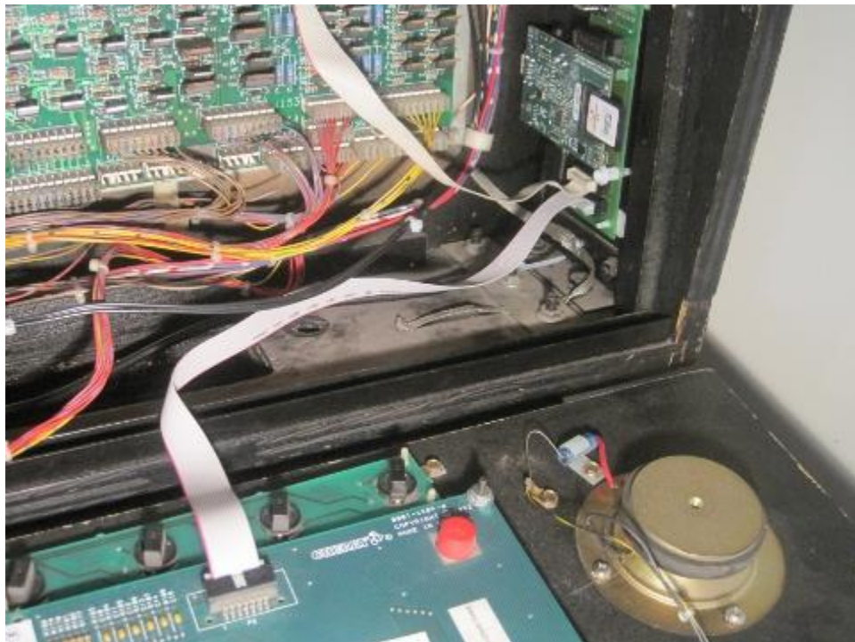
Bild 11 – Mitgeliefertes Flachbandkabel komplett montiert
