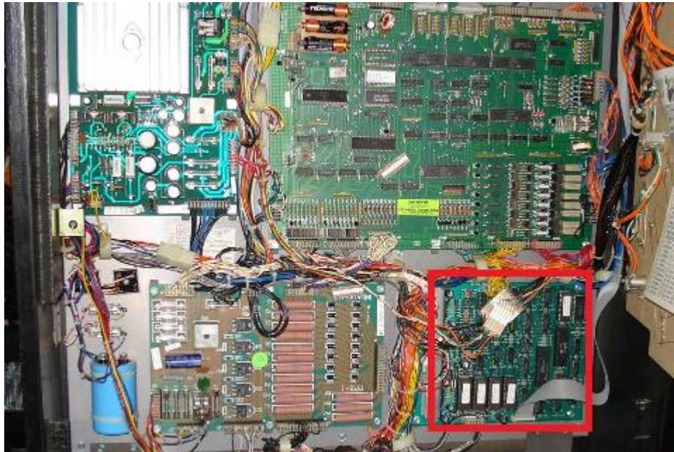
Bild 13 – Sound Board rot markiert
