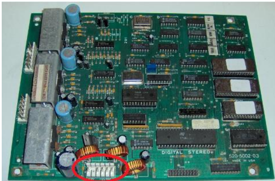
Bild 14 – Stecker CN2 rot markiert
